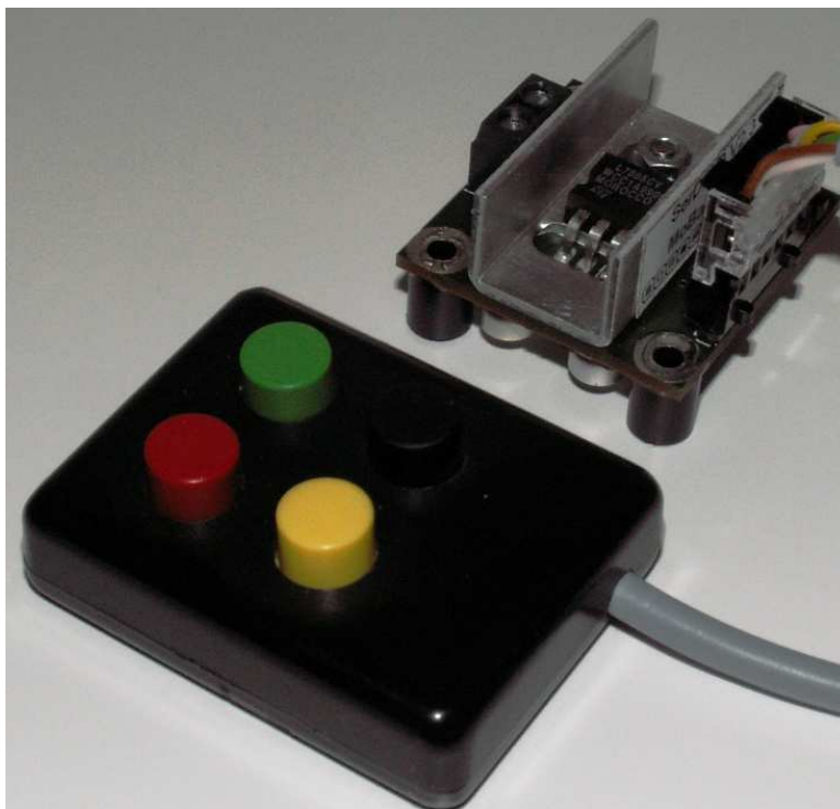
Abbildung 11 – Kleines Handbediengerät an der 6-poligen Pfostenleiste angeschlossen
